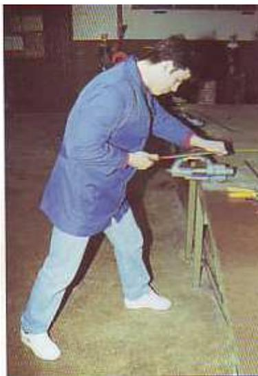
Fig. 3. Posición correcta de limado.
